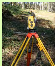
自動追尾型トータルステーションを利用した 施工基面の高さ確認状況
