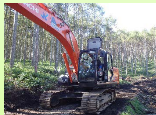
自動操縦を行うバックホウ
