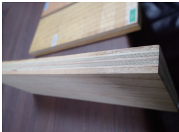
写真4 スギ合板(12mm)の両面にセンダン挽板(4mm)を貼り合わせた国産早生広葉樹ハイブリットパネル(PLT)
