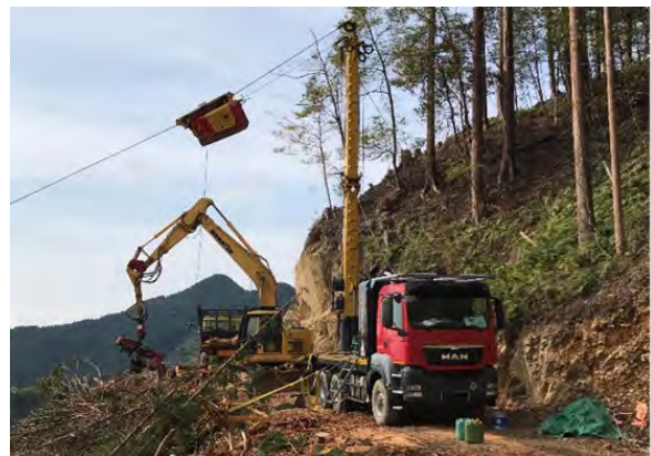
トラック搭載大型タワーヤーダ等による集材・造材作業
