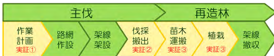
作業工程のフロー図と3つの実証事項
