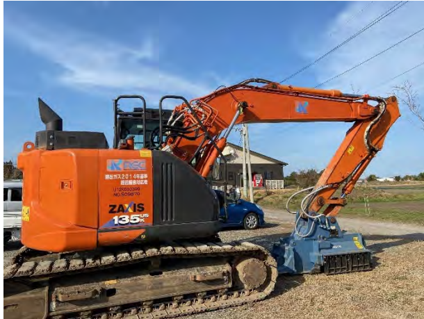
バックホー草刈りアタッチメントクラッシャー (NIKKEN 製 NKB120 ベースマシンは0.4 クラス)
