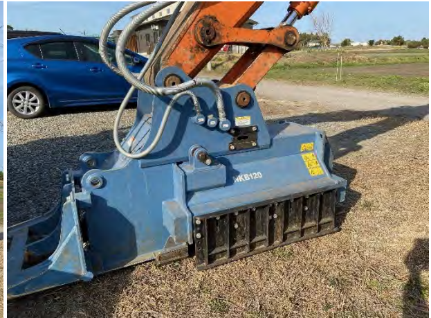
バックホー草刈りアタッチメントクラッシャー (NIKKEN 製 NKB120 ベースマシンは0.4 クラス)
