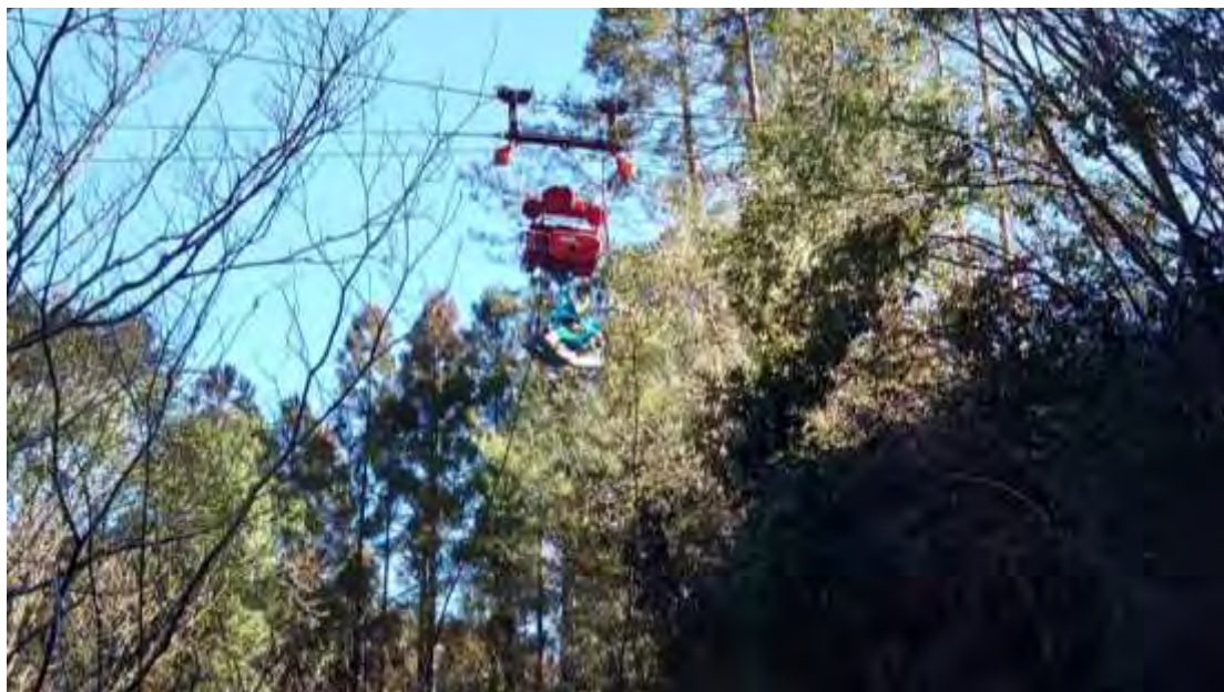
写真－7 中尾根を越せなかった架線グラップル
