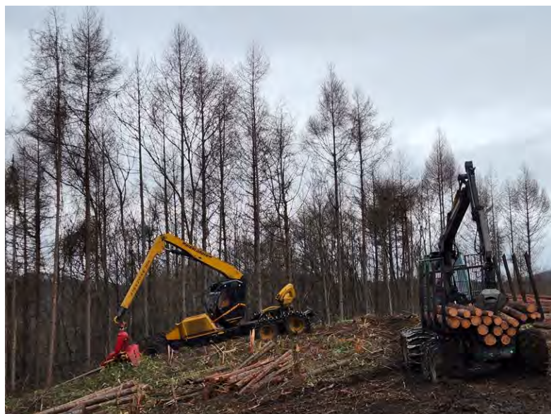
図 33 CTL 作業システムの作業状況
