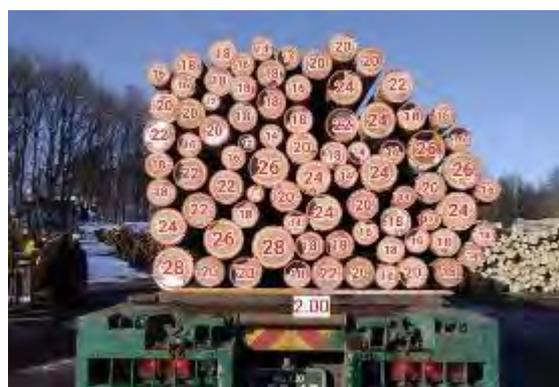
図15 木材検収システムによる本数確認
