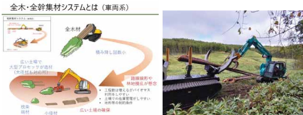
図Ⅱ-12 クラムバンクスキッドを使ったWT作業システム:施業地が大きく木寄せ・集材距離が長くなる場合は、WT作業システムにおいて本機械で代替できる可能性が示された
