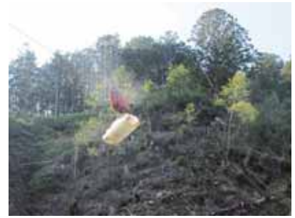
集材架線を利用した運搬
