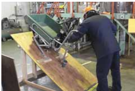
図Ⅱ-19 登坂状態を模した試験： 平地と同様の植栽作業可能
