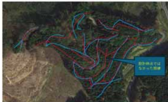
■人力設計（青線）と開設路網測量（赤線）の路線形の比較 ■FRD（黄線）と開設路網測量（赤線）の路線形の比較
