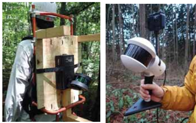
図4 使用した背負子レーザ Hovermap (左) ハンディレーザ LiGrip (右)
