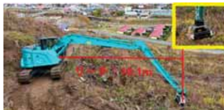
左：令和4・5年度のマルチャー（ノーマル）、右：令和6年度のロングリーチマルチャー・ヘッド直角取り付け
