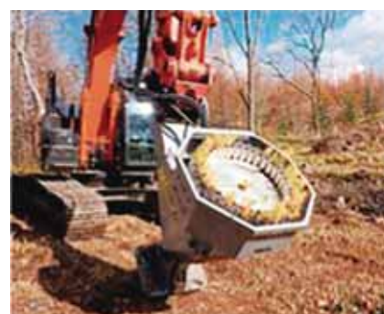
自動植付け機(苗の装填部)
