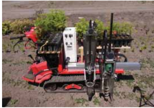
図Ⅱ-18 昨年度までに開発した植栽機の全景 (林産試だより 24 年 8 月で報告)
