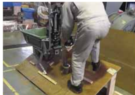
図Ⅱ-20 等高線方向の植栽： ユニットが地面と干渉
