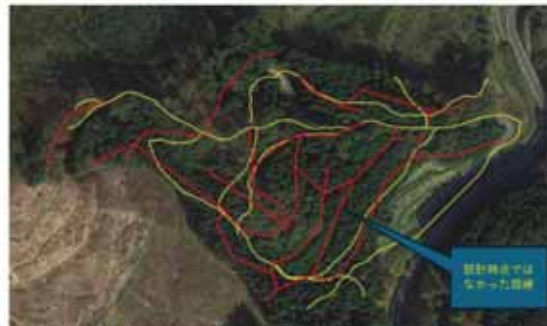
■人力設計（青線）と開設路網測量（赤線）の路線形の比較 ■FRD（黄線）と開設路網測量（赤線）の路線形の比較
