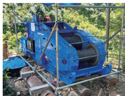
リモコン式油圧集材機
