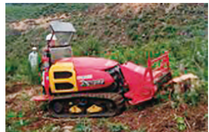
乗用刈払機による伐根処理
