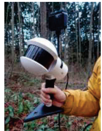
図3. 使用した背負子レーザ Hovermap (左) ハンディレーザ LiGrip (右)
