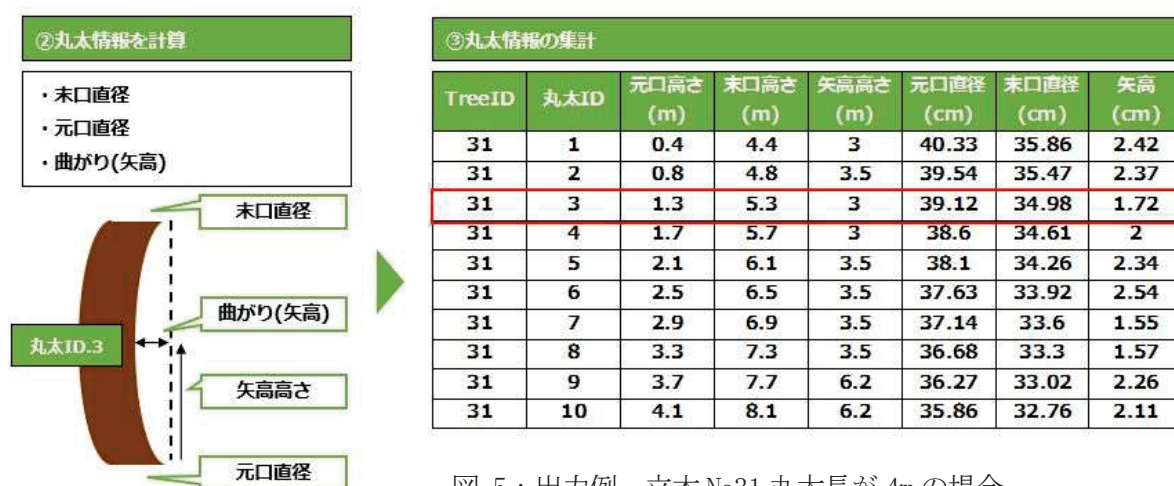
図-5：出力例 立木 No31 丸太長が 4m の場合、矢高が最小な造材は元口 1.3m から末口 5.3mm で造材する
