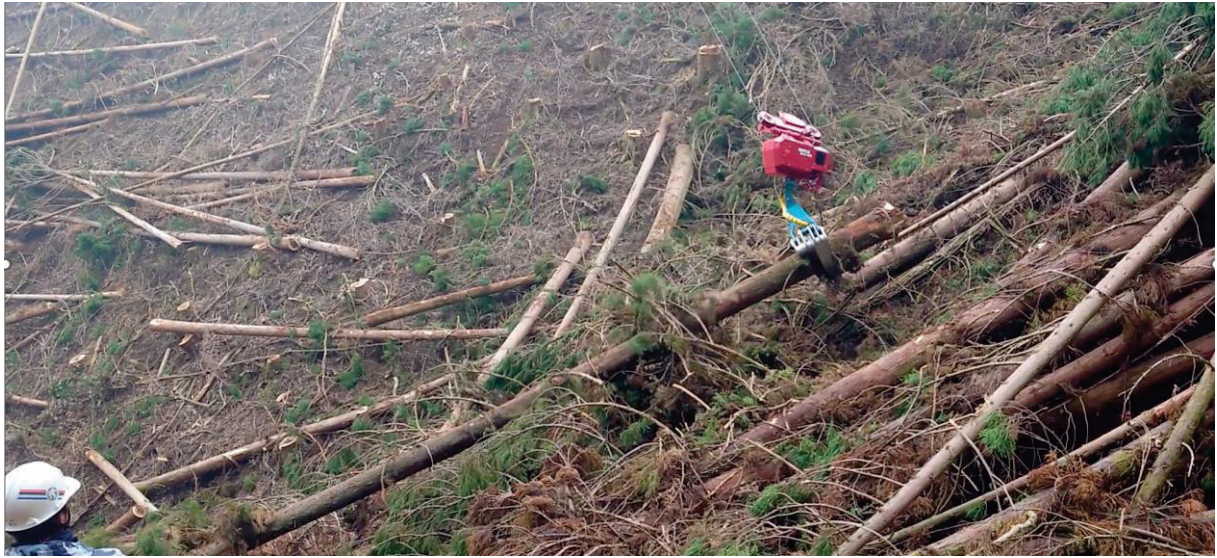
写真 2-2-11 架線グラップルによる集材作業
