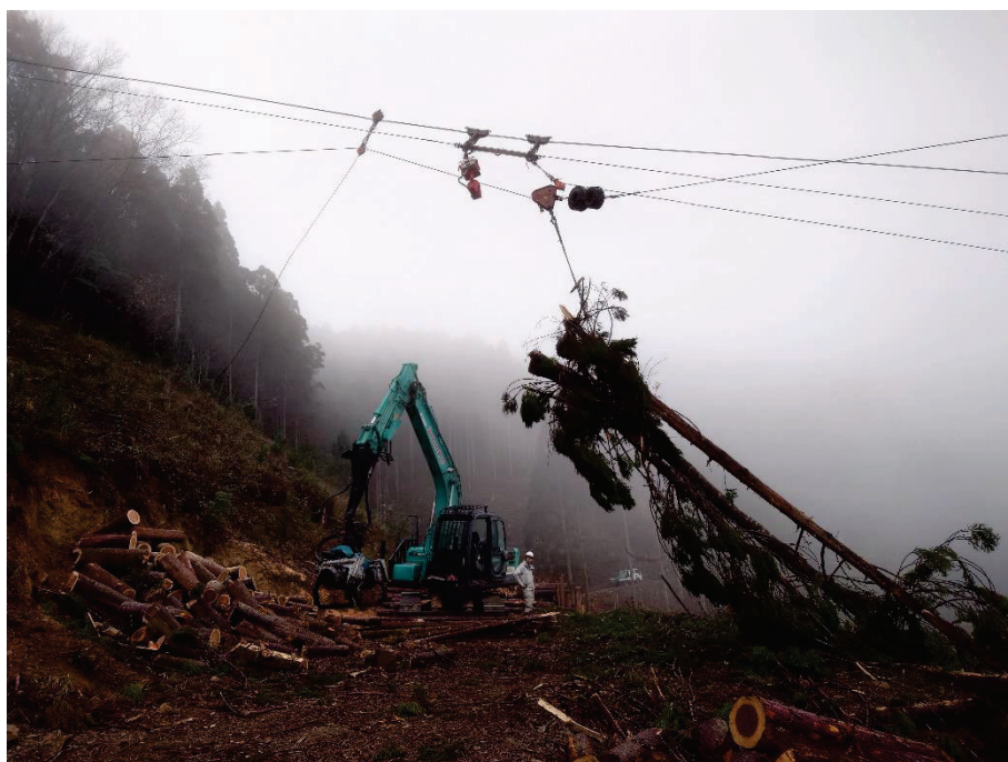
写真 2-2-10 ローチン人力荷掛けによる集材作業
