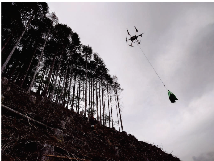
図 2-2-21 DJI Agras T30 による苗木（2 袋 50 本）の運搬作業
