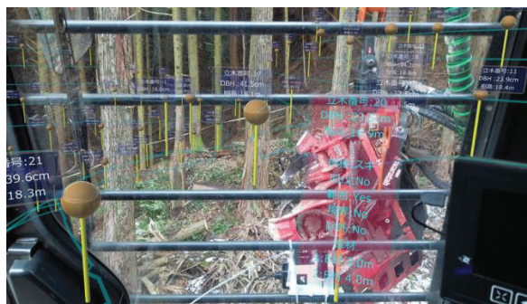
図 8 スマートグラスに表示される立木位置と最適造材情報
