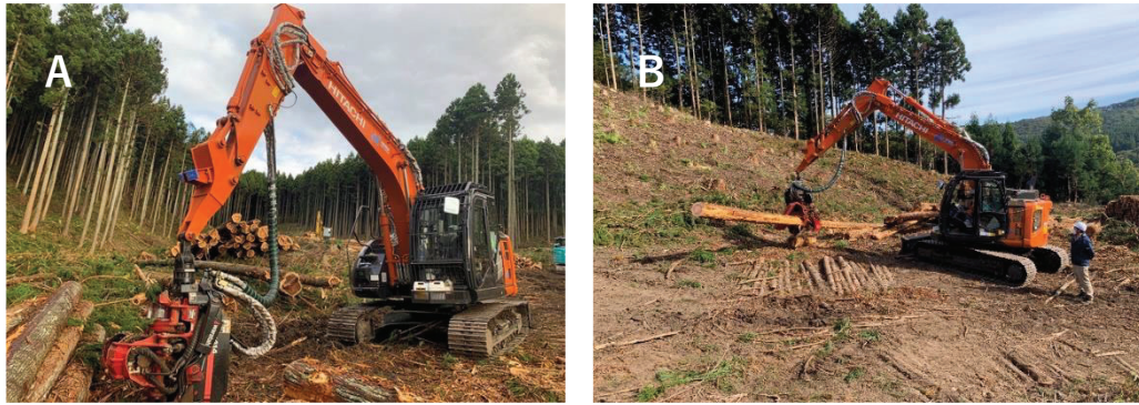
図 2-1 ICT ハーベスタによる造材作業
