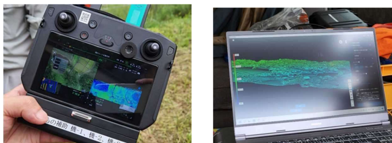
図 13 ドローンレーザ計測実施状況
