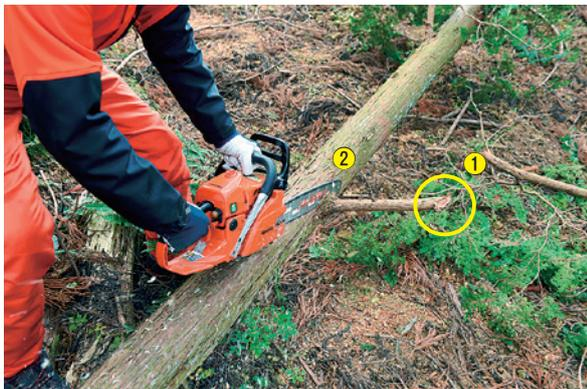
Foto 11-8 Pemotongan dahan yang panjang dua kali
