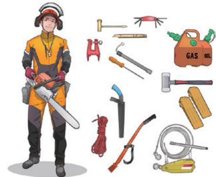
Gambar 1-9 Contoh perlengkapan keselamatan (pekerjaan penebangan pohon, pemotongan kayu, pengumpulan kayu)
