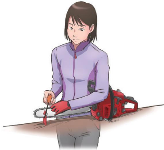
**Gambar 4-1** Posisi pengasahan yang baik adalah dengan merentangkan kaki Anda ke depan dan ke belakang membentuk garis lurus sejajar, dan ketiak bagian tangan yang memegang kikir dirapatkan kemudian siku, tangan, dan kikir digerakkan secara horizontal dengan membentuk garis lurus.
