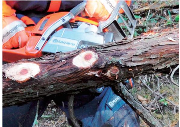
Foto 11-7 Memotongnya dengan halus di sepanjang permukaan kayu
