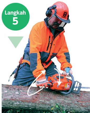
Selanjutnya gunakan pergelangan tangan dan siku kanan untuk meletakkan gergaji mesin pada pohon yang ditebang dengan arah terbalik pada langkah 2 dan sekali lagi perhatikan perubahan posisi genggaman tangan kiri di sini. Untuk memudahkan perpindahan posisi genggaman, sistem 6 titik memerlukan penggunaan sarung tangan yang mudah digerakan.
