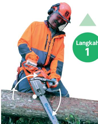
Dengan menggunakan tepi depan bagian bawah gergaji mesin sebagai titik tumpu saat diletakkan di atas pohon yang ditebang, gunakan gerakan tuas pengungkit untuk memotong dahan. Dari sini, lanjutkan ke langkah 2 sambil memasang batang pemandu pada pohon yang ditebang.
