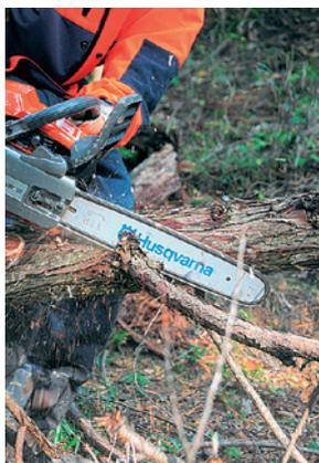
Foto 11-4 Penerapan pengungkit - pemotongan dengan pisau bagian bawah batang pemandu (sisi bawah)
