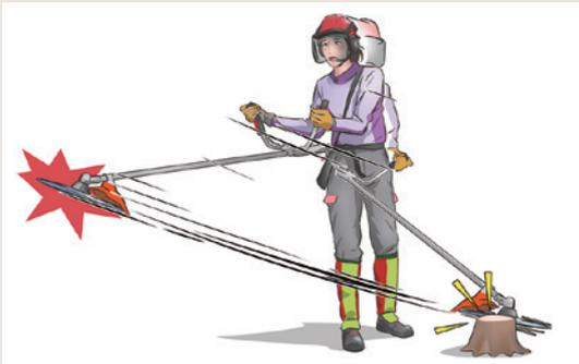
Putaran balik (gergaji) dari mesin pemotong rumput yang memantul ke arah kanan
