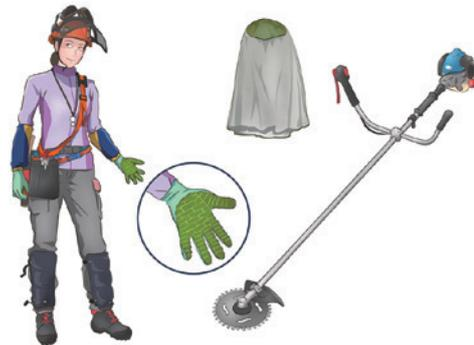
Gambar 1-8 Contoh perlengkapan keselamatan (pekerjaan pemotongan semak belukar)
