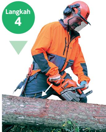
Selanjutnya sambil menopang bagian bawah kiri belakang gergaji mesin dengan bagian atas lutut kiri, gerakkan gergaji mesin ke depan bersamaan dengan menggerakkan pusat gravitasi tubuh bagian atas ke depan (dengan kata lain, jarak gerak maju gergaji mesin) langkah 2 hingga 5 adalah ini hanya untuk pergeseran pusat gravitasi tubuh bagian atas saja. (Jangan pernah berjalan).
