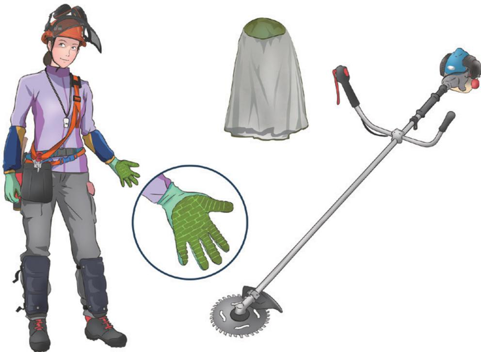
Gambar 8-2 Pakaian dan peralatan yang dikenakan selama pekerjaan pemotongan semak belukar
