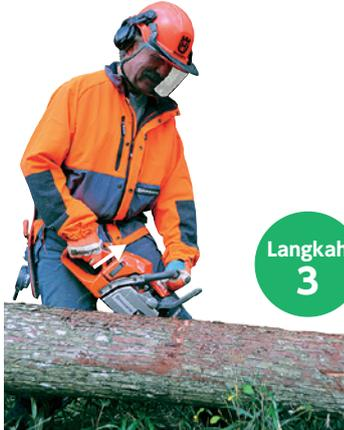
Pertama, letakkan berat gergaji mesin di pojok kanan bawah (terlihat seperti titik, bukan garis), dan jika ada cabang yang harus di potong, gunakan ini sebagai titik tumpu untuk memotong cabang tersebut.
