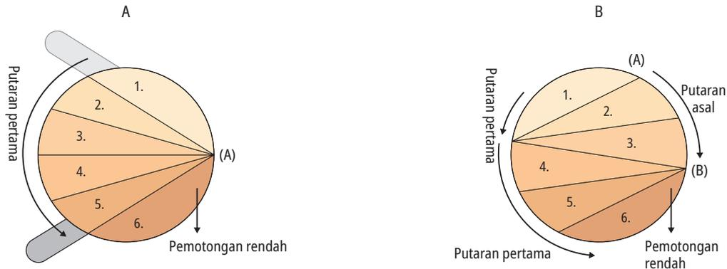
Gambar 11-4 Pemotongan kayu gelondongan ketika panjang batang pemandu lebih panjang dari diameter kayu
