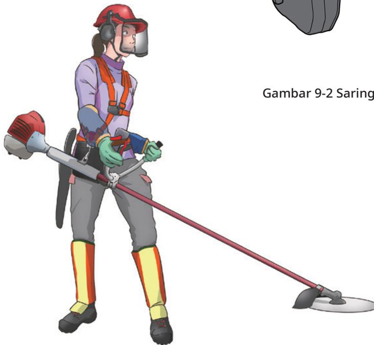
Gambar 9-3: Mesin pemotong rumput terpasang dengan benar
