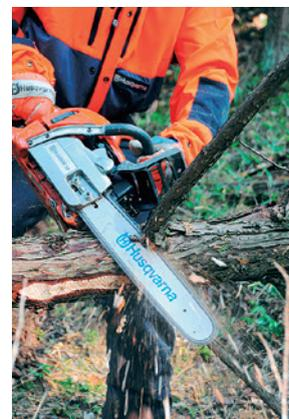
Foto 11-5 Penerapan pengungkit - pemotongan dengan pisau bagian atas batang pemandu bawah (sisi atas)
