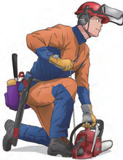
図 15-10 地面に置いて始動させる時の姿勢
