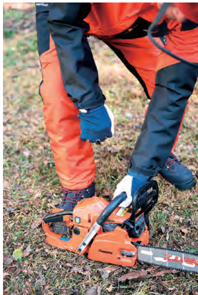
写真6-1 リコイルスターターを引いてエンジンをかける
