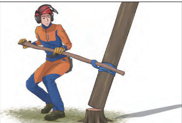
図 19-9 かかっている木にターニングストラップを巻きつけ、てこ棒をアイに通して、木回しと同じように回転させてははずします。
