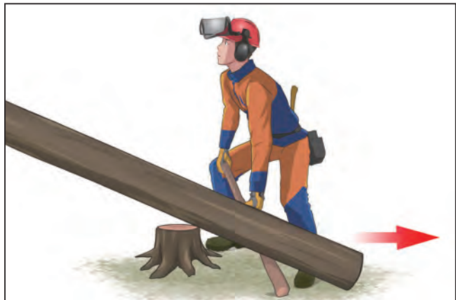
図 19-10 つるの処理の例—かかり木を回転させる場合
