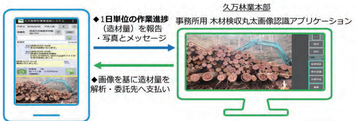
図2-9 1日単位で丸太生産量を正確に把握できる画像認識アプリを利用した方法
