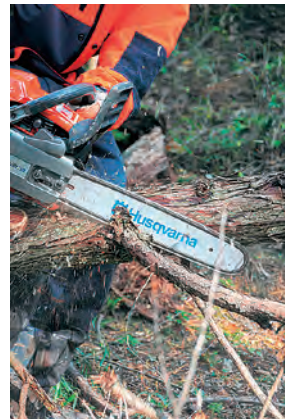
写真13-4 てこの応用ー ガイドバーの下刃(下側) での切り下げ
