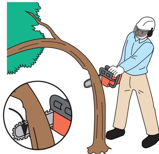
図 13-4 下から削っていき、徐々に張力を解放します。
