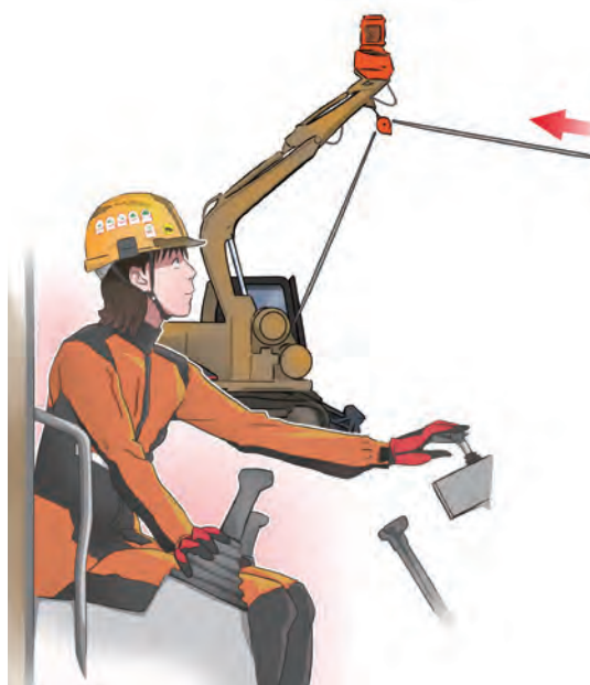
図 19-1 車両系木材伐出機械等でかかり木処理を行います。
