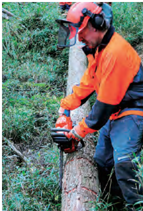
写真13-2 チェーンソーの支え方ー 幹に重さを預ける
