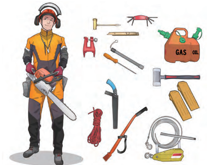
図 15-12 チェーンソー作業時の服装と保護具、伐倒に使用する道具一式(例)
