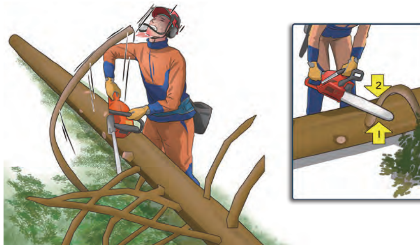
図13-5 材等に押さえられ弓状になっている枝は、反発力を弱めるための切り込みを入れてから根元切りをします。
