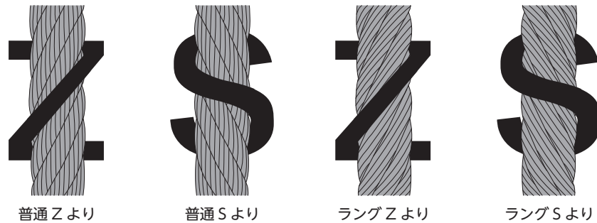
図7-2 ワイヤロープのより方
