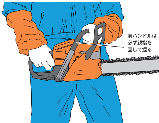
図 15-7 チェーンソーの正しい持ち方
