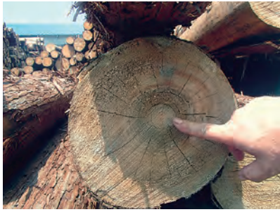
写真13-13 合板原木として使えない芯腐れの材
