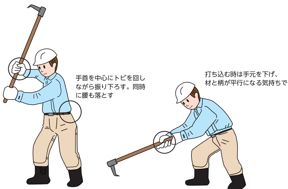
ず 図 20-7 トビの使い方 アーチを描くように材に打ち込みます。
