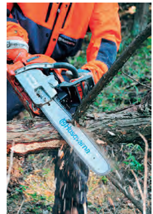
写真13-5 てこの応用ー ガイドバーの上刃(上側)で の切り上げ
