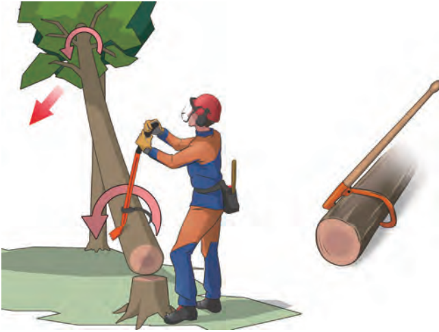
図 19-5 木回し、フェリングレバー等を使って、かかり木をはずします。
