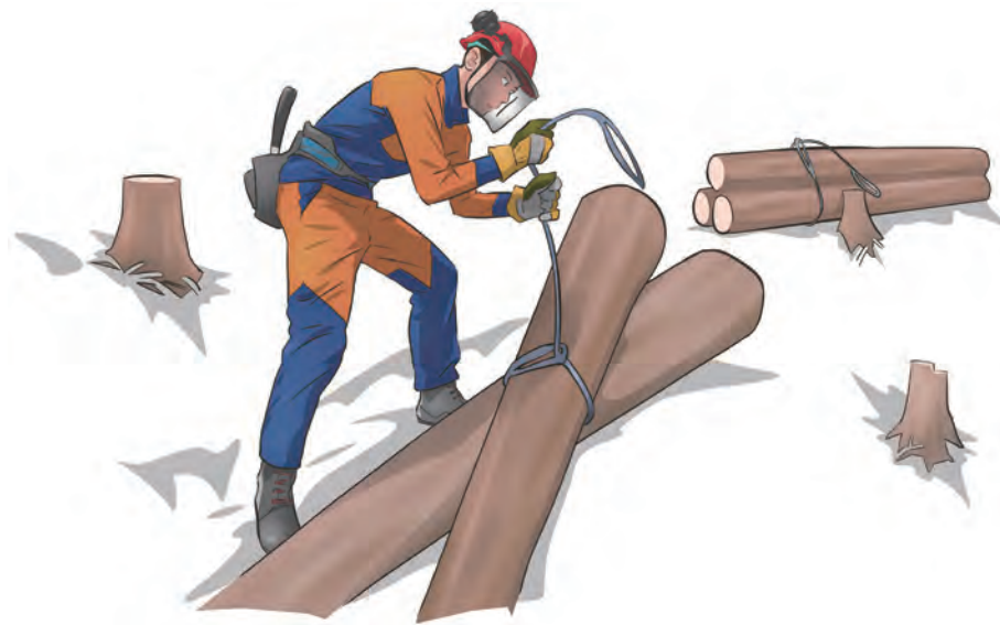
図20-13 荷かけは斜面の上側から行う
