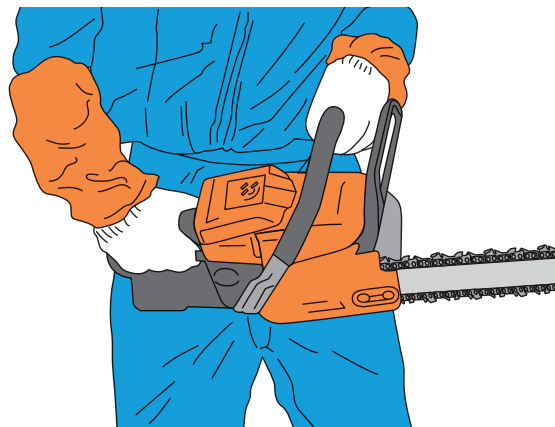
図 15-9 斜め切りの時の持ち方
