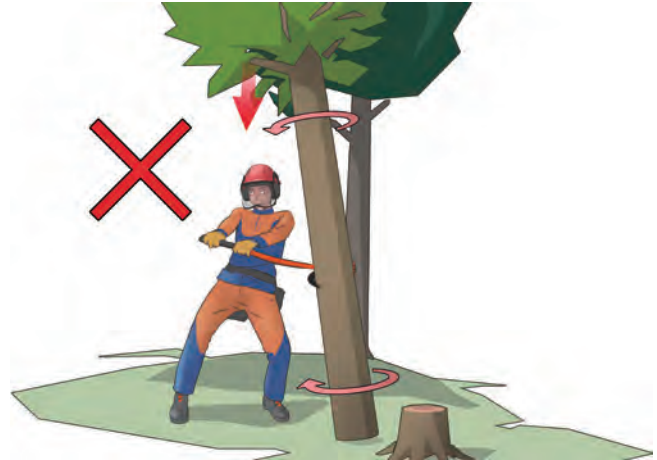
図 19-6 かかっている木の下に入ってはいけません。回転する時は、押す方向に回します。
