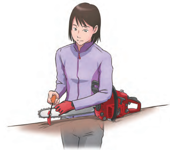
図6-17 良い目立てのフォームは、前後に開いた両足をほぼ同一線上にし、ヤスリを持つ手は脇を締めて、肘、手、ヤスリが一直線に水平に送り出せる体勢です。
