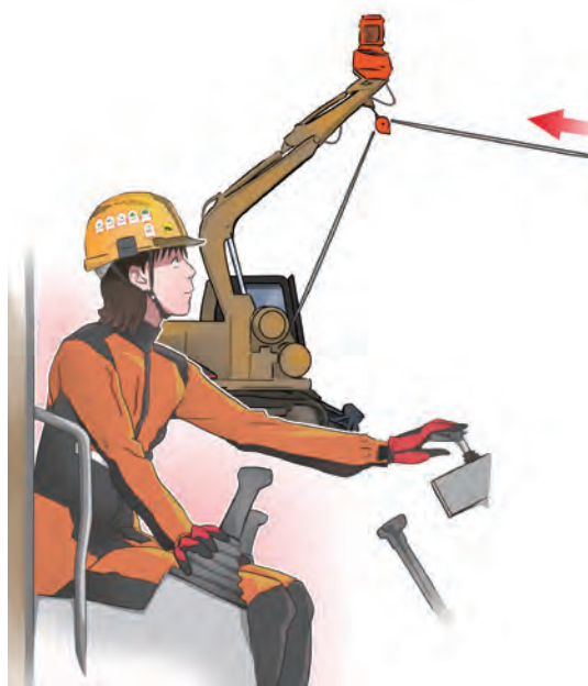
Gambar 19-1: Penanganan pohon yang tersangkut dengan mesin penebangan dan pengangkut kayu beroda.
