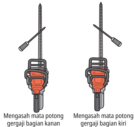
Gambar 6-21 Pengasahan mata potong gergaji bagian kanan dan kiri
