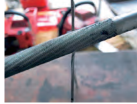
Foto 5-6 Pengasahan gigi gergaji yang miring dengan kikir bulat
