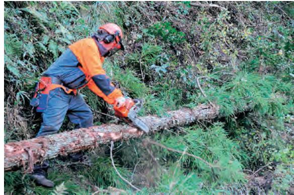
Foto 13-6: Pemotongan dahan dilakukan di sisi lereng dari pangkal pohon menuju ke ujung
