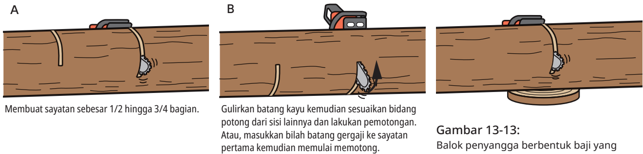
Gambar 13-12: Metode memotong dua tahap dengan menggulingkan batang kayu
