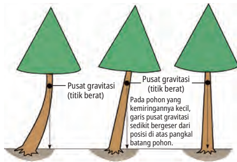
Gambar 17-1: Kondisi pohon - Pemeriksaan arah titik berat (pusat gravitasi)
