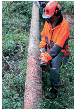
Foto 13-3: Cara menopang gergaji mesin – Gunakan kaki kiri dan batang pohon sebagai tumpuan
