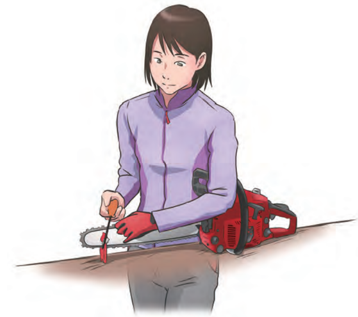
Gambar 6-17 Posisi pengasahan gigi gergaji yang baik adalah dengan merentangkan kaki ke depan dan ke belakang membentuk garis lurus sejajar, dan ketiak bagian tangan yang memegang kikir dirapatkan kemudian siku, tangan, dan kikir digerakkan secara horizontal dengan membentuk garis lurus.
