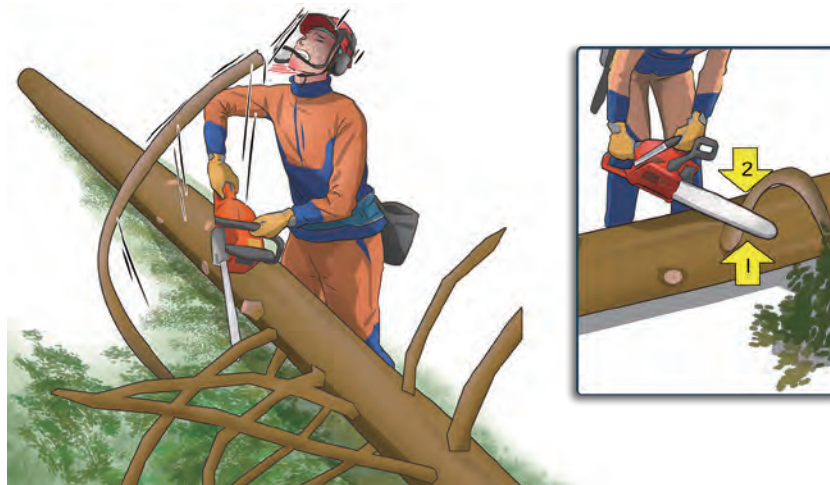
Gambar 13-5: Dahan yang melengkung karena tertekan oleh batang atau benda lain harus diberi sayatan terlebih dahulu untuk mengurangi gaya pantul, kemudian dipotong dari pangkalnya.
