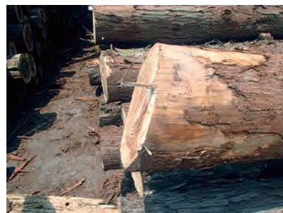
Foto 13-15: Kayu dengan ujung potongan (pangkal kayu) miring yang tidak dapat digunakan sebagai bahan baku kayu lapis
