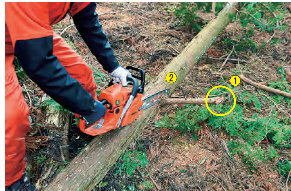
Foto 13-8: Pemotongan dahan yang panjang dilakukan dua tahap
