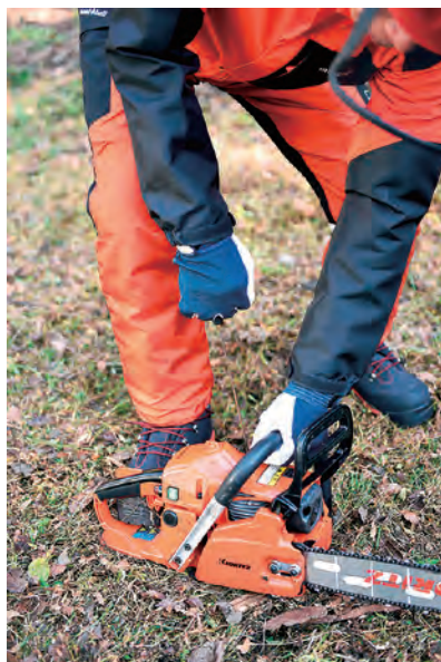
Foto 6-1 Menarik recoil starter untuk menyalakan mesin
