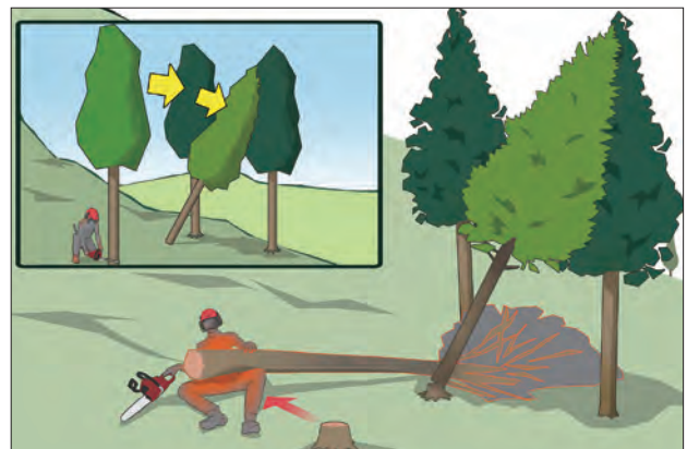
Gambar 18-3: Saat mencoba menjatuhkan pohon di sebelahnya dengan metode penebangan dengan gaya tarik (penebangan dengan menjatuhkan ke pohon lainnya), penebang tertimpa pohon yang ditebang
