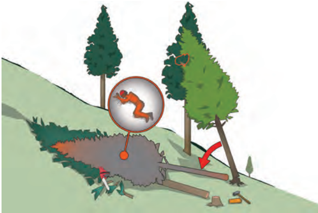
Gambar 19-15: Pekerja membiarkan begitu saja pohon yang tersangkut, dan ketika memotong dahan pohon lain yang berada di bawahnya, pohon yang tersangkut tumbang dan menghantam korban
