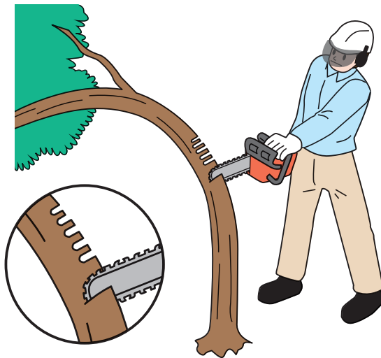
Gambar 13-2: Pohon muda atau dahan yang tertekan tanah dan melengkung itu berbahaya, jadi tentukan dahulu bagian dengan tegangan tertinggi sebelum bekerja.
