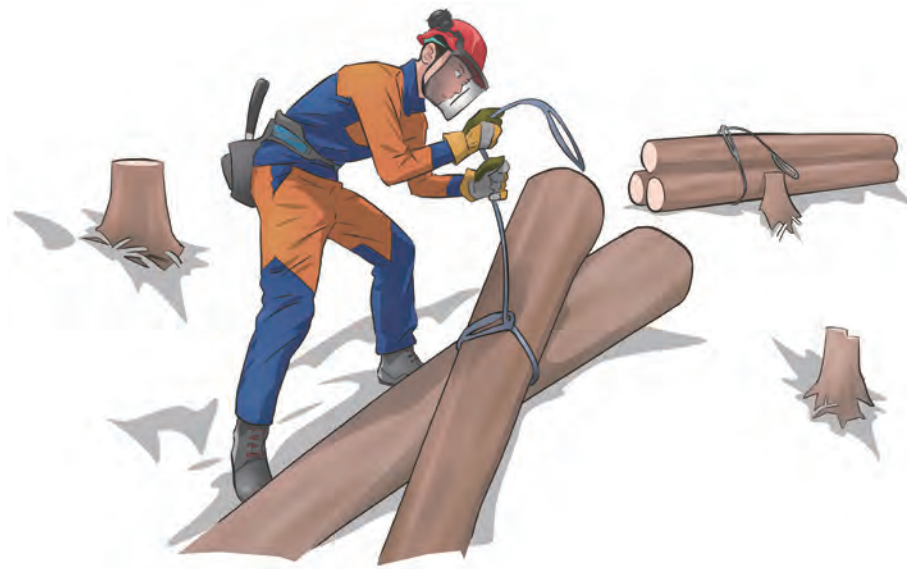
Gambar 20-13: Pemasangan beban dilakukan dari sisi atas lereng
