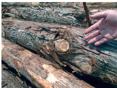
Foto 13-14: Kayu dengan mata kayu tinggi yang tidak dapat digunakan sebagai kayu gelondongan untuk papan lapis
