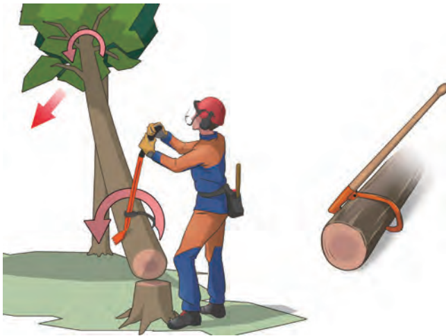
Gambar 19-5: Menggunakan pemutar batang kayu, tuas penebangan, dan sebagainya untuk melepaskan pohon yang tersangkut.
