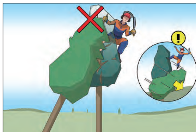
Gambar 18-11: Jangan memanjat pohon yang tertimpa untuk memotong cabang
