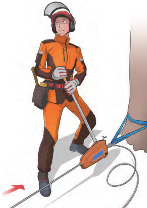
Gambar 19-3: Menggunakan alat penarik.
