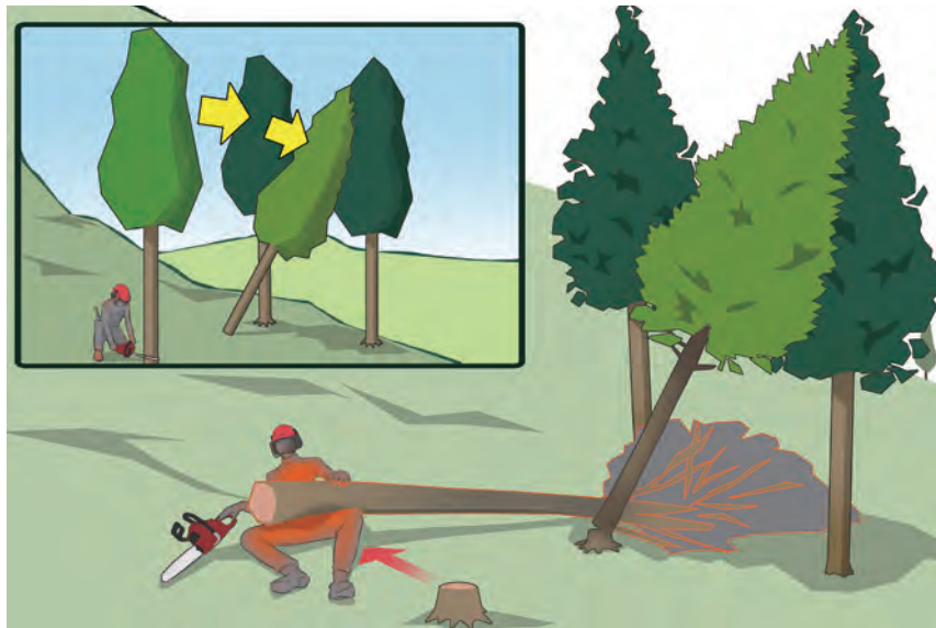
Gambar 15-23: Pekerja tertimpa pohon setelah mencoba menjatuhkan pohon di sebelahnya dengan metode “penebangan dengan gaya tarik” (penebangan dengan menjatuhkan ke pohon lainnya)
