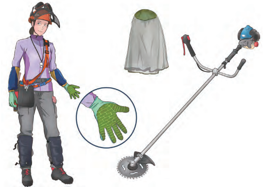
Gambar 10-4 Pakaian dan peralatan yang dikenakan selama pekerjaan pemotongan semak belukar
