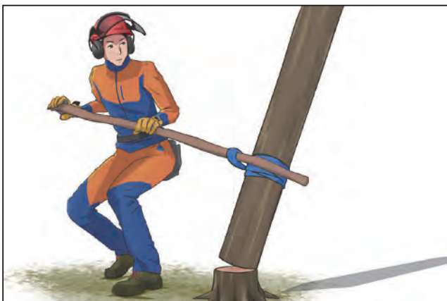
Gambar 19-9: Pasang tali pembalik pada pohon yang tersangkut, masukkan batang tuas ke dalam mata tali pembalik tersebut, dan putar pohon sampai lepas seperti halnya menggunakan alat pemutar pohon.
