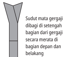
Gambar 5-13 Setelan sudut mata gergaji hanya dilakukan dengan sedikit membengkokkan ujung mata pisau
