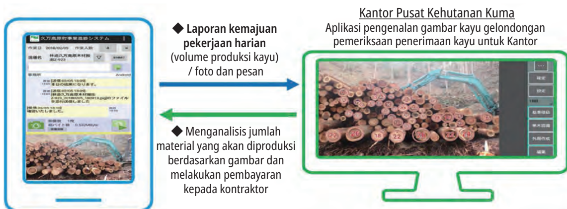
Gambar 2-9 Metode Menggunakan Aplikasi Pengenalan Gambar untuk Memperoleh Data Akurat Produksi Log Harian
