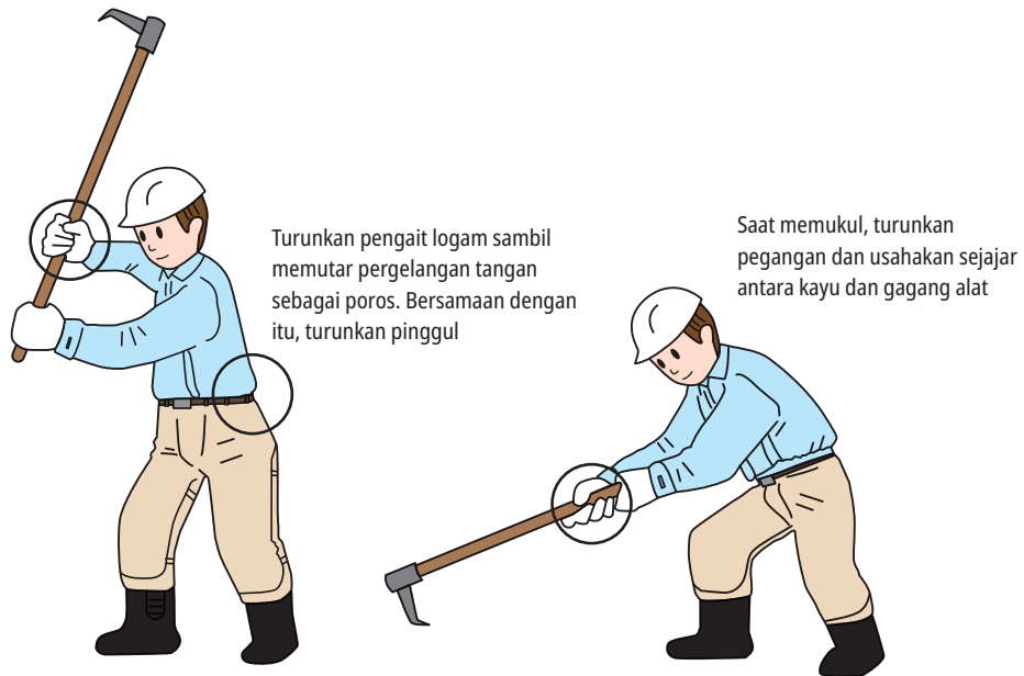
Gambar 20-7: Cara menggunakan pengait logam
