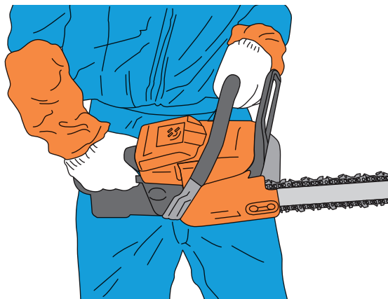
Gambar 15-9: Cara memegang gergaji mesin saat melakukan potongan miring
