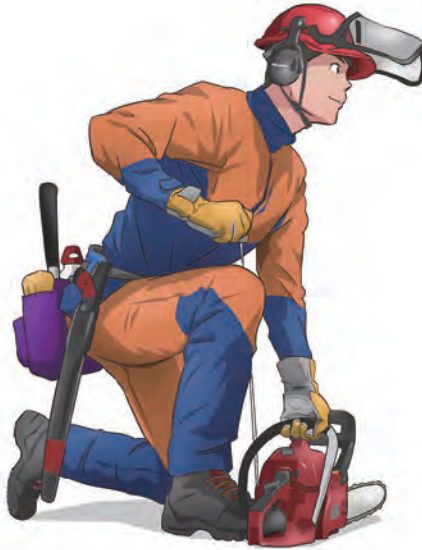
Gambar 15-10: Posisi tubuh saat menyalakan gergaji mesin di tanah
