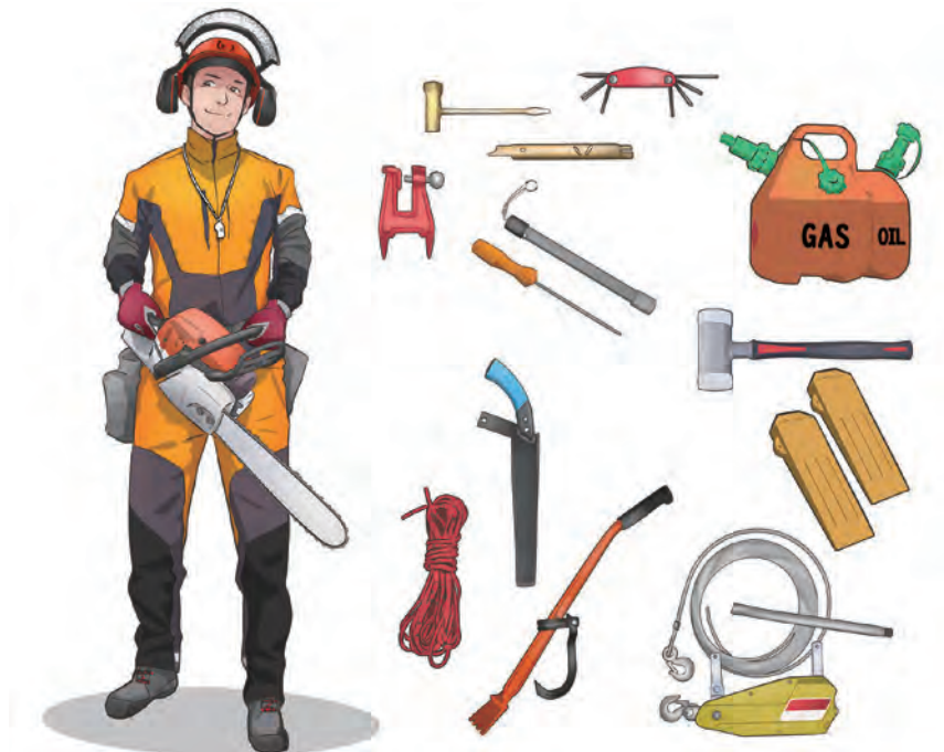
Gambar 15-12: Pakaian dan alat pelindung saat bekerja dengan gergaji mesin, serta satu set perlengkapan untuk penebangan pohon (contoh)
