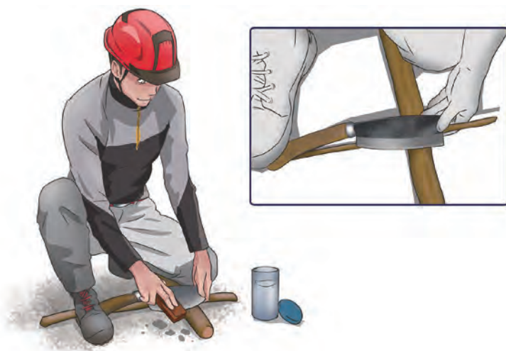
Gambar 7-17 Mengasah golok dengan batu asah portabel
