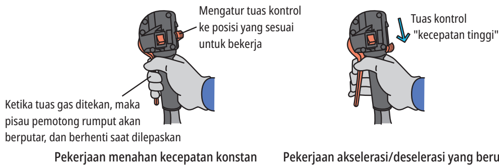
Gambar 5-6 Contoh mekanisme gas tuas picu
