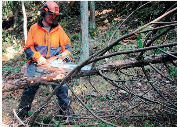
Foto 13-1: Tinggi yang ideal untuk pekerjaan pemotongan dahan
