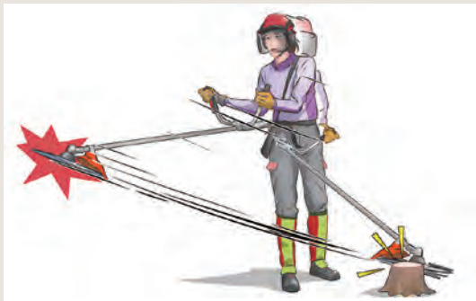
Tendangan balik (kickback) dari mesin pemotong rumput yang memantul ke arah kanan
