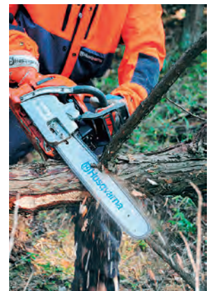
Foto 13-5: Penerapan prinsip tuas – Potongan menaik dengan sisi atas (bagian atas) bilah batang gergaji
