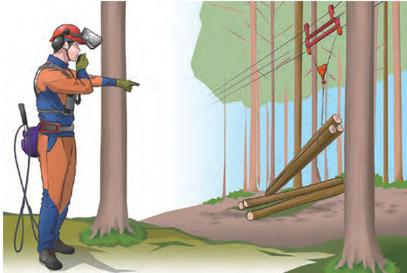
Gambar 20-1: Dalam pekerjaan pengumpulan kayu, pastikan aba-aba dan evakuasi dilakukan dengan tepat
