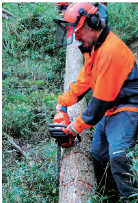
Foto 13-2: Cara menopang gergaji mesin – Menyandarkan berat pada batang pohon
