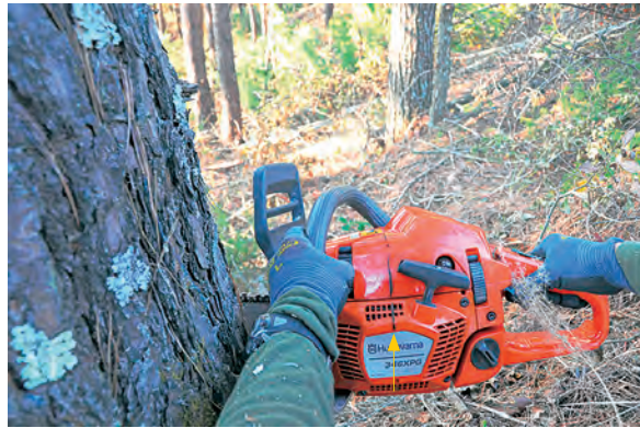
Foto 15-1: Membidik arah penebangan dengan menggunakan tanda 'gun mark' atau garis bidik (tanda panah pada gergaji mesin) sebagai acuan
