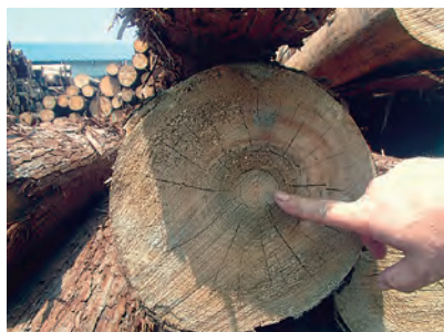
Foto 13-13: Kayu dengan inti busuk yang tidak dapat digunakan sebagai kayu gelondongan untuk papan lapis
