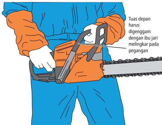
Gambar 15-7: Cara memegang gergaji mesin yang benar
