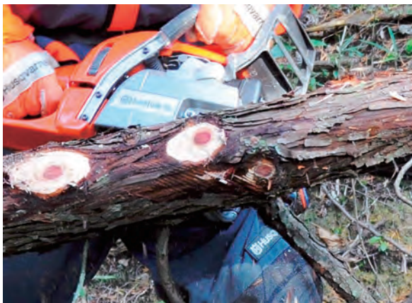
Foto 13-7: Potong sejajar dengan permukaan batang
