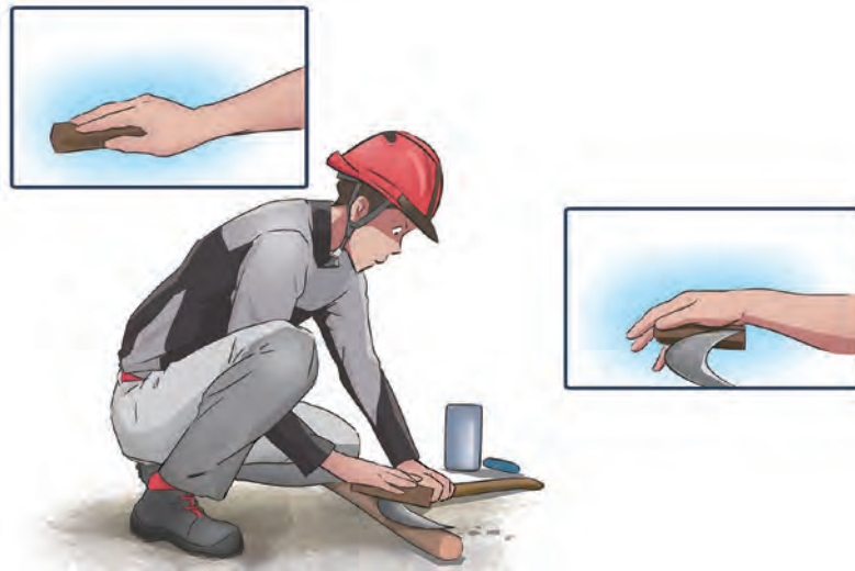
Gambar 7-16 Mengasah sabit dengan batu asah portabel
