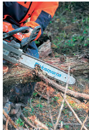
Foto 13-4: Penerapan prinsip tuas – Potongan menurun dengan sisi bawah (bagian bawah) bilah batang gergaji
