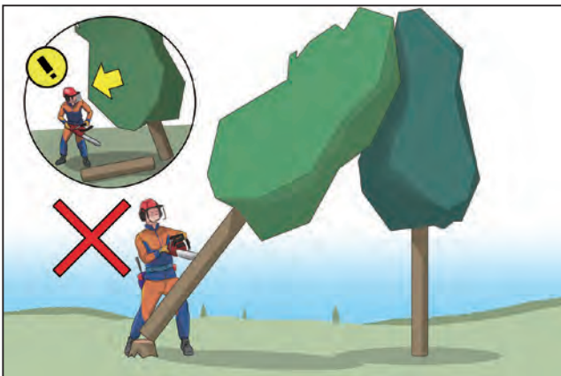
Gambar 18-9: Jangan melakukan pemotongan bagian pangkal batang pada pohon yang tersangkut
