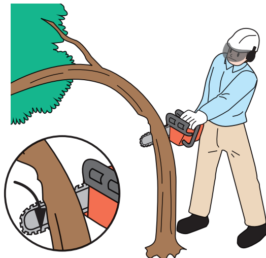
Gambar 13-4: Lanjutkan dari bawah untuk melepaskan tegangan secara bertahap.
