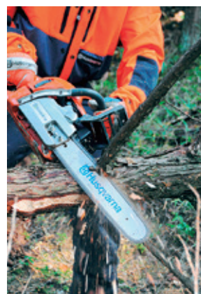
写真11-5 てこの応用ーガイドバーの上刃(上側)での切り上げ
