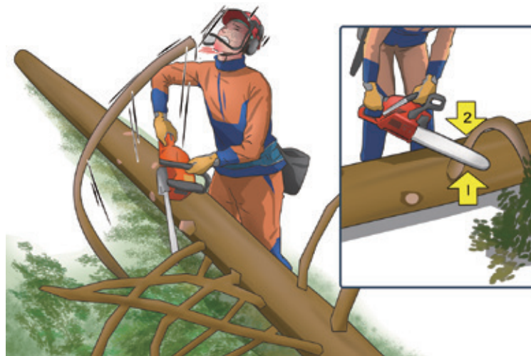
図 11-1 伐倒木に弓なりに引っかかっていた枝などが裂けて弾けると危険です。
