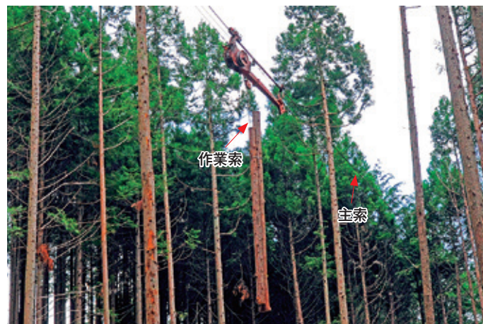
写真5-1 架線集材では主索（ラングより）の上を搬器を行き来させ、丸太を運搬します。作業索（普通より）で丸太を吊るしています。
