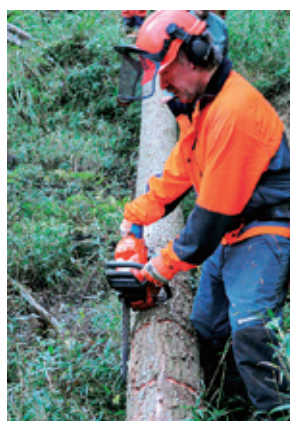
写真11-2 チェーンソーの支え方ー幹に重さを預ける
