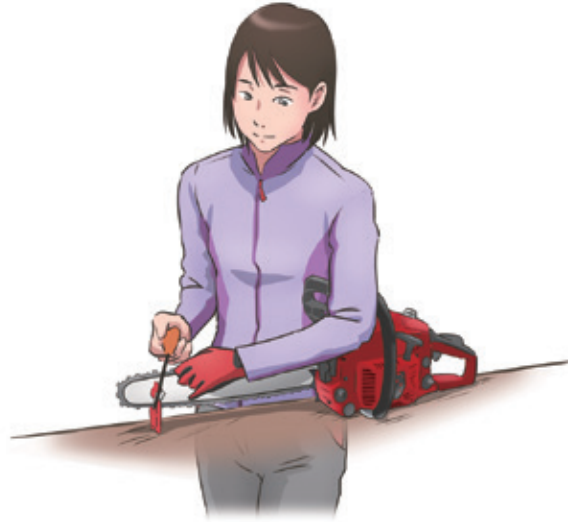
図4-1 良い目立てのフォームは、前後に開いた両足をほぼ同一線上にし、ヤスリを持つ手は脇を締めて、肘、手、ヤスリが一直線に水平に送り出せる体勢です。
