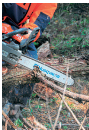
写真11-4 てこの応用ーガイドバーの下刃(下側)での切り下げ
