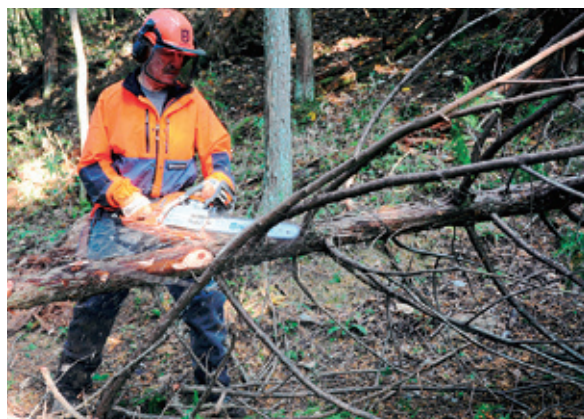
写真11-1 枝払い作業を進めやすい高さ 腰下から膝までの間で枝の切り払いができる高さが体への負担が小さい高さです。
