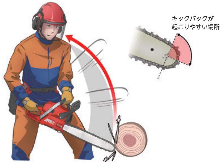
図10-7 ガイドバーの根元を使い、キックバックに注意する
