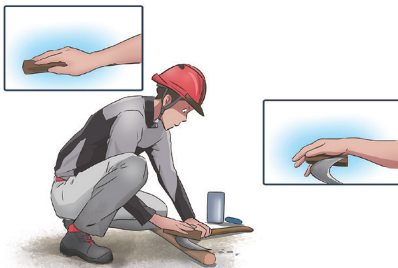
Hình 5-14 Khi mài liềm bằng đá mài cầm tay
