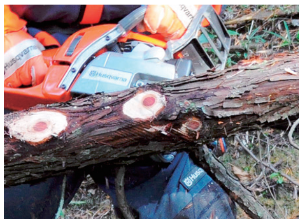
Ảnh 11-7 Cắt mịn dọc theo bề mặt gỗ
