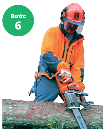
Hình 11-3 Phương pháp cưa cãnh 6 điểm nhìn từ mặt bên(2)
