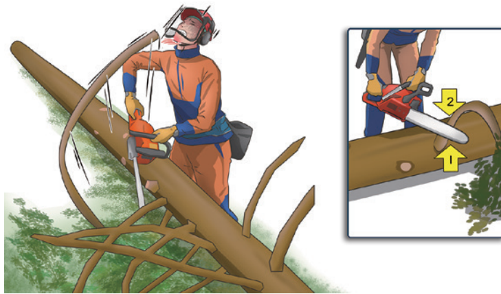
Hình 10-9 Sẽ rất nguy hiểm nếu phần gốc của cành cây bị cắt nảy lên va vào người
