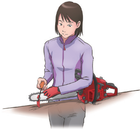
Hình 4-1 Tư thế mài chuẩn là: dang hai chân ra trước và sau sao cho hai chân trên cùng một đường thẳng, tay cầm giữa khếp chặt vào hông sao cho khuỷu tay, bàn tay và giữa có thể cử động thẳng hàng theo chiều ngang.
