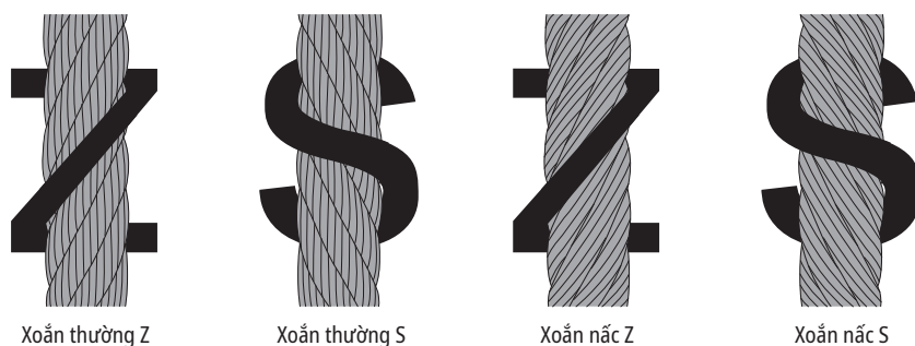
Hình 5-2 Cách xoắn dây cáp
