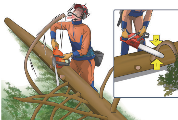
Hình 11-1 Nếu một cành cây bị cây đổ xuống tạo thành hình cánh cung bị gãy và nứt ra sẽ rất nguy hiểm.
