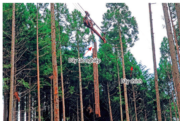
Ảnh 5-1 Trong quá trình thu gom gỗ bằng dây, gỗ được vận chuyển bằng cách di chuyển giá đỡ tới lui trên dây chính (xoắn tằng). Các khúc gỗ được treo trên dây tác nghiệp (xoắn thường).
