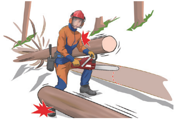
Hình 11-11 Làm việc ở chân dốc có thể nguy hiểm nếu gỗ bị lăn xuống.
