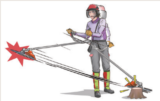
Giật ngược khi dao cắt cỏ nảy sang bên phải
