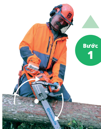
Hình 11-3 Phương pháp cưa cành 6 điểm nhìn từ mặt bên(1)
