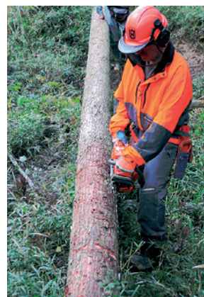
Ảnh 11-3 Cách đỡ máy cưa xích - Đỡ bằng chân trái và thân cây
