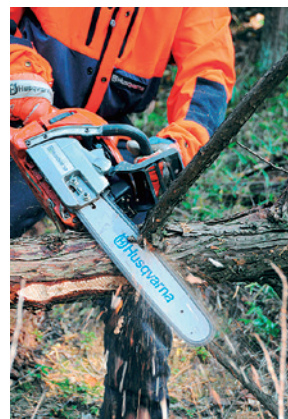
Ảnh 11-5 Ứng dụng phương pháp đòn bẩy - cắt bằng lưỡi trên (phía trên) của thanh dẫn hướng
