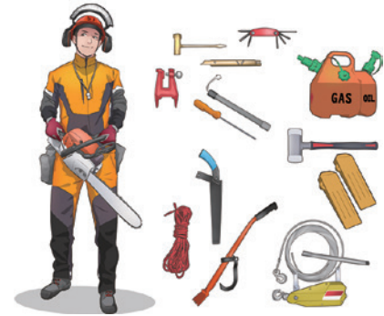
Hình 1-9 Ví dụ về trang thiết bị an toàn(Khai thác gỗ/Xẻ gỗ/ Thu gom gỗ)
