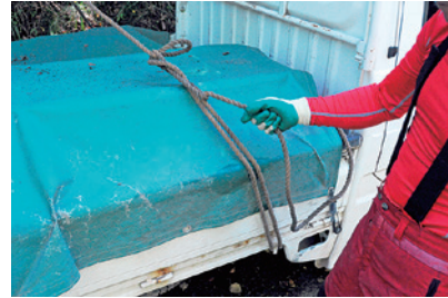
Ảnh 5-5 Nút thắt Nam Kinh. Ngay trước khi thực hiện các bước trong Hình 5-13
