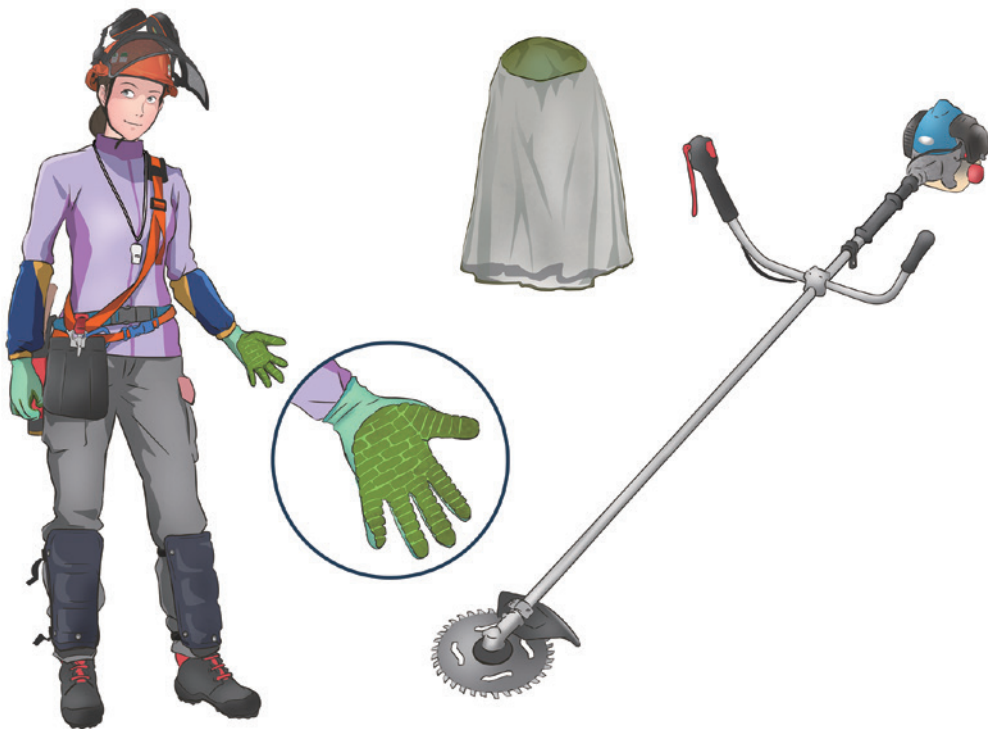
Hình 8-2 Quần áo/Trang bị khi thực hiện công việc cắt cỏ
