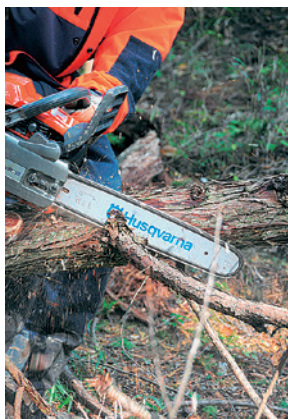
Ảnh 11-4 Ứng dụng phương pháp đòn bẩy - cắt bằng mép dưới (mặt dưới) của thanh dẫn hướng
