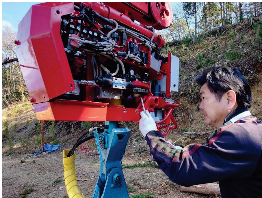
写真 2-2-12 グラップルの旋回部分の緊急修理
