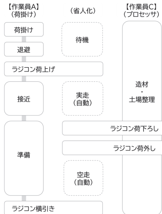
図 2-2-4 油圧集材機とローチン人力荷掛けによる作業工程（2オペ）
