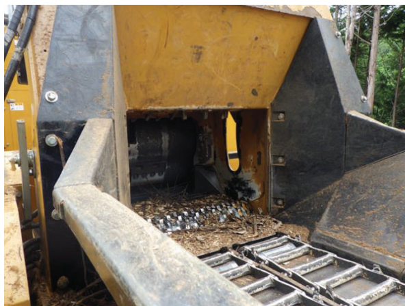
木材破砕機に搭載されている切削刃
