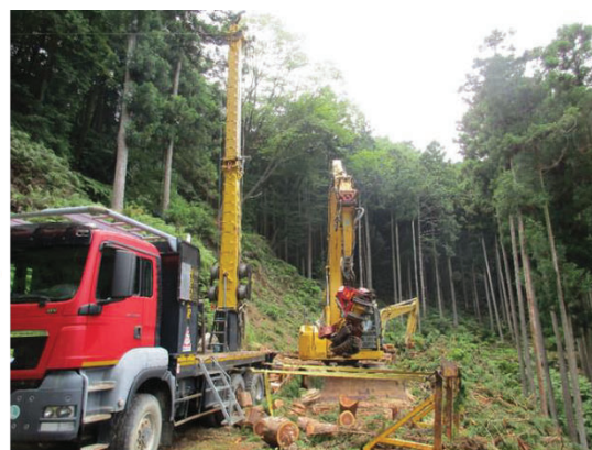
架線計画シミュレーション結果 を基にした主伐作業
