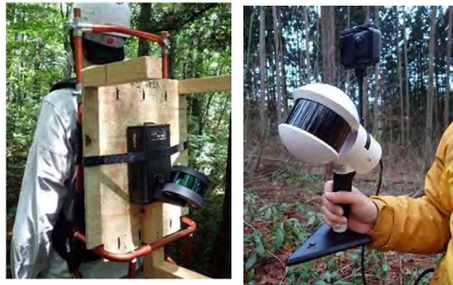
図3. 使用した背負子レーザ Hovermap (左) ハンディレーザ LiGrip (右)
