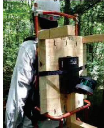
図3. 使用した背負子レーザ Hovermap (左) ハンディレーザ LiGrip (右)
