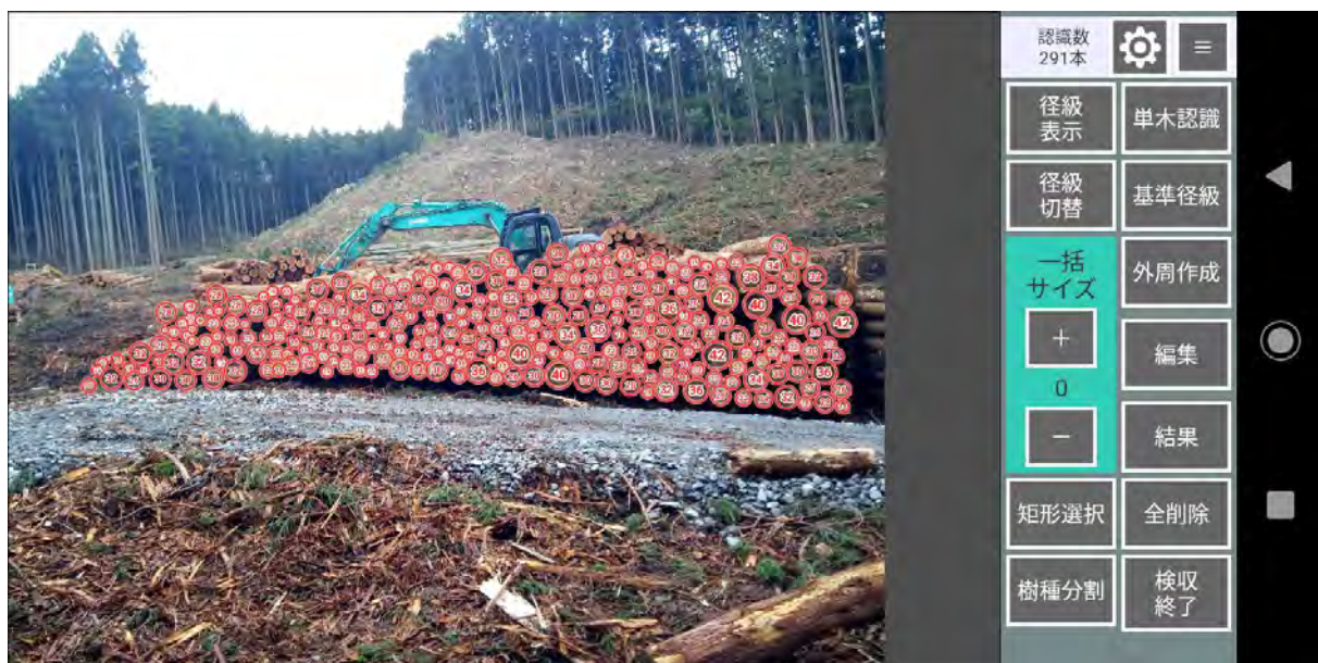
木材検収システム操作中画面① 単木認識方式 単木認識及び径級読込
