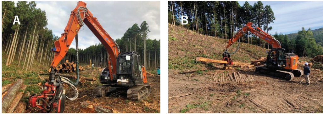
図 2-1 ICT ハーベスタによる造材作業
