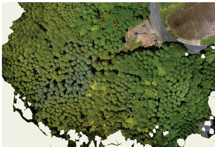
図-2. 実証対象地1(上野物産社有林)における素材生産前のドローンによる樹高計測
