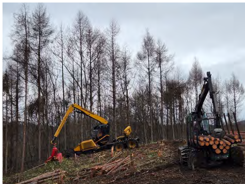
図 33 CTL 作業システムの作業状況
