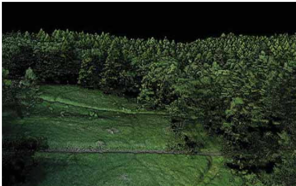
図Ⅱ-2 LiDAR 搭載 UAV では、着色された林分の詳細な 3D 点群モデルデータをフライト中リアルタイムに取得できる
