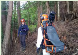
3Dレーザ計測の実施状況
