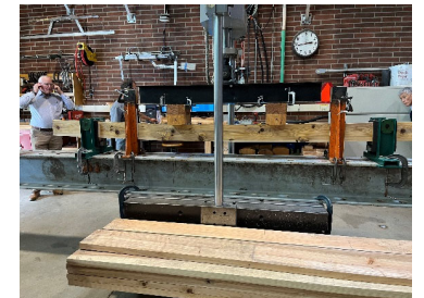
米国検査機関でのスギの強度試験(令和6年6月、オレゴン州立大学)
