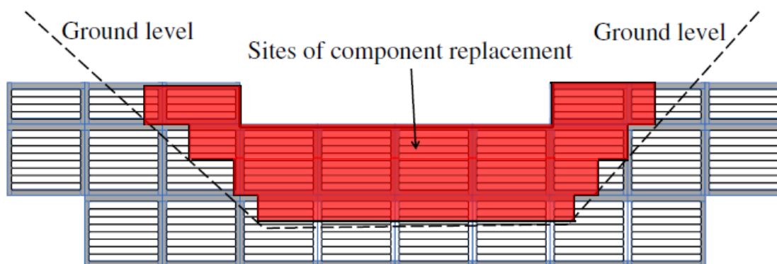
図 3-145 ハイブリッドダムの補修箇所 (Noda et al., 2014)
