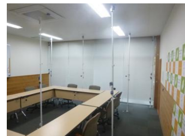
図 3-112 計測器の設置箇所 (木造庁舎の会議室)
