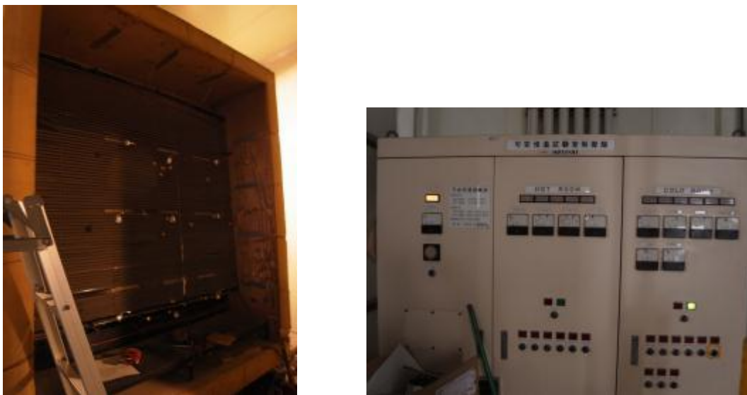
図 3-49 断熱性能測定試験機（可変高温試験室）
