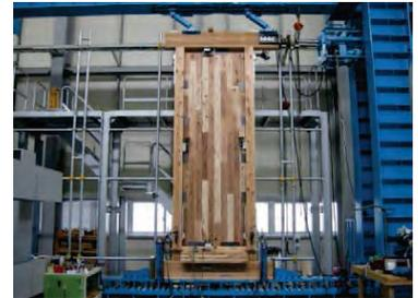
2 床へのCLTの活用では、ビス1本当たりの要素試験を実施し、そのデータから、床構面の耐力を計算により算定し活用。なお、実大水平構面試験を実施し、算定した耐力との整合を確認している。
