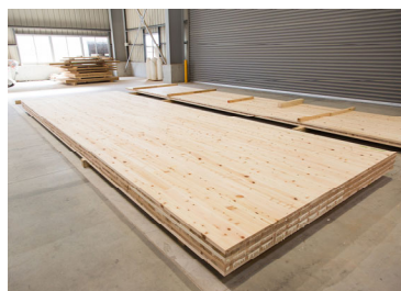
国内初のCLT量産工場 最大サイズ0.27×3×12m
