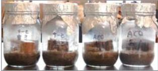
写真4 木材腐朽測定試験状況（保存処理材試験材）
