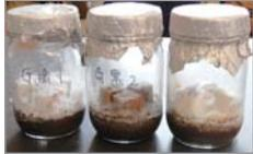
写真3 木材腐朽測定試験状況（無処理試験材）
