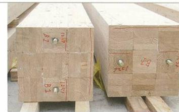
部材中央の十字（左図中の白色部分）が構造として荷重を負担する部材で、ビスのみにより接合。四隅の部材（黒色）は合せ柱で燃え残り断面による設計を行う場合、十字の構造部分について温度上昇を防ぐために、ポリウレタン接着により固定しています。
