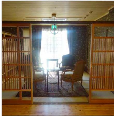
スプリンクラー設備と排煙設備を設けることにより、内装制限の適用除外とし、天井にも木材が使用可能となっている。
