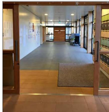
活動エリアの玄関及び廊下の床材は、安全性に配慮したゴムチップのタイルを採用している。外靴のまま入館できる。
