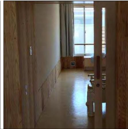
失禁など、様々な入居者の状況に対応できるよう、全居室のうち3割は、床に長尺シートを張り（写真右）、残りの居室及びパブリックリビングはフローリングを張っている（写真左）。
