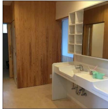
各居室ユニットに備わるコンパクトな水廻りは、清掃の面から床は長尺シートを張り、壁と建具は木質化している。
