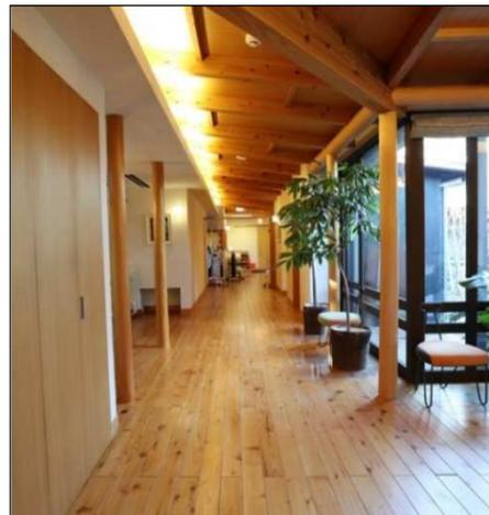
柱及び登梁は珞、床は珞フローリング、天井（一部）及び建具にも木を用い、木に包まれた温かみのある空間を形成している。内装制限が適用される天井の一部には準不燃珞化粧合板が用いられている。
