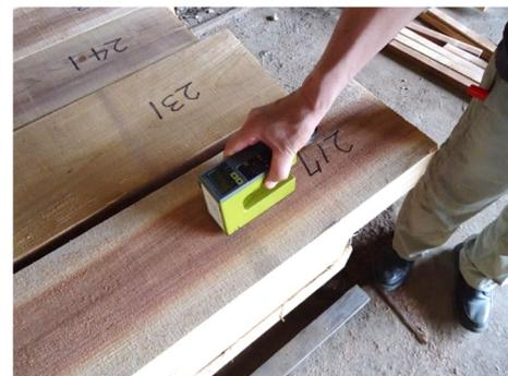
図3 含水率の計測例
