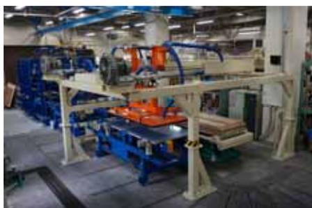
CLT製造装置を開発し効率的製造方法を検討
