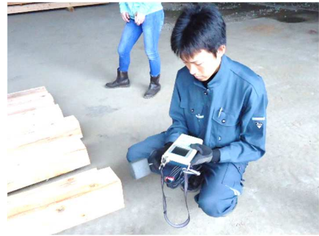
図4 縦振動法によるヤング係数の計測例
