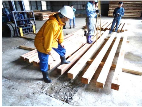
図4 縦振動法によるヤング係数の計測例
