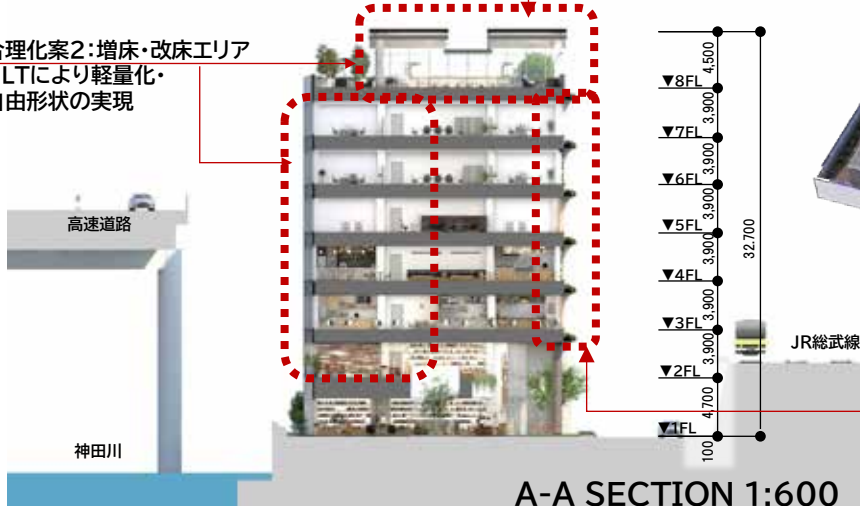
合理化案1:最上階エリア WIGID®による無柱空間の実現
