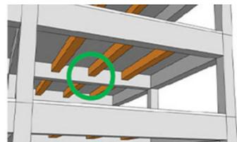
木造小梁とRC造大梁の混構造建築イメージ
