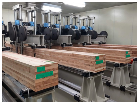
9層9プライCLTの長期挙動の測定
