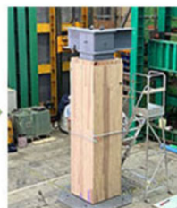
被覆施工完了
