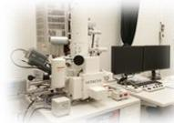
【装置の例】高分解能走査電子顕微鏡
