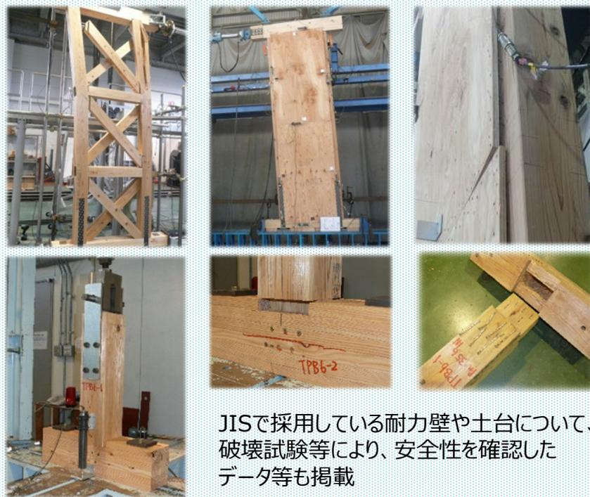
JISで採用している耐力壁や土台について、破壊試験等により、安全性を確認したデータ等も掲載
