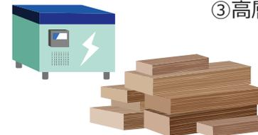
④蓄電池、CLT（Cross Laminated Timber；ひき板を繊維方向が直交するように積層接着したパネル。同面積のコンクリートと比較して軽い、施工が早いといった特徴を有する。）
