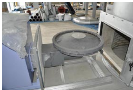
写真 7.4 国産ペレット焚き温水ボイラーとバーナーの構造（二光エンジニアリング）
