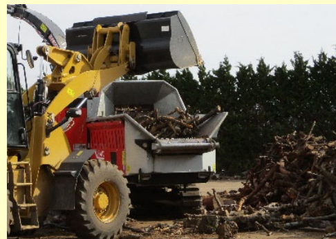
移動式チップパーでのチップ化
