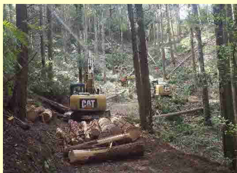
プロセッサにより、その場で造材・選別
