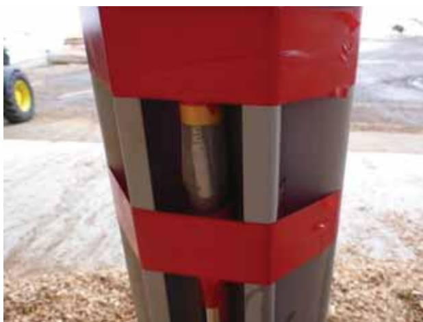
写真 6.3 地上高 2.0mセンサー設置状況 (P8) 埋設前
