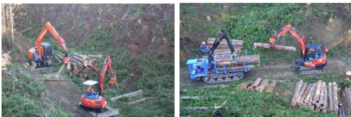
図表 6-10 左：造材・極積み作業、右：積み込み・小運搬作業
